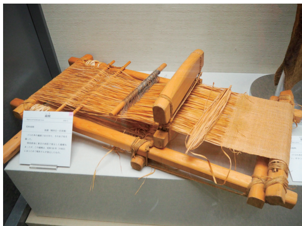
図6：織機（横井庄一による復元品）、長102.0cm 幅69.0cm ラワン・竹製、1983年（2018年5月 筆者撮影）
